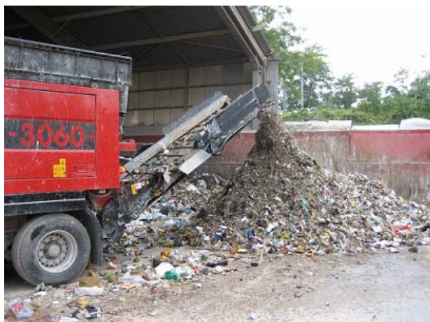
Figure 77 : Broyage grossier de l'échantillon de déchet
