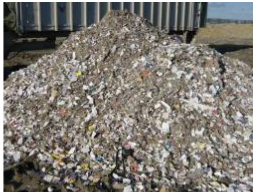
Figure 32 : Fines du centre de tri utilisées pour couverture journalière des casiers
