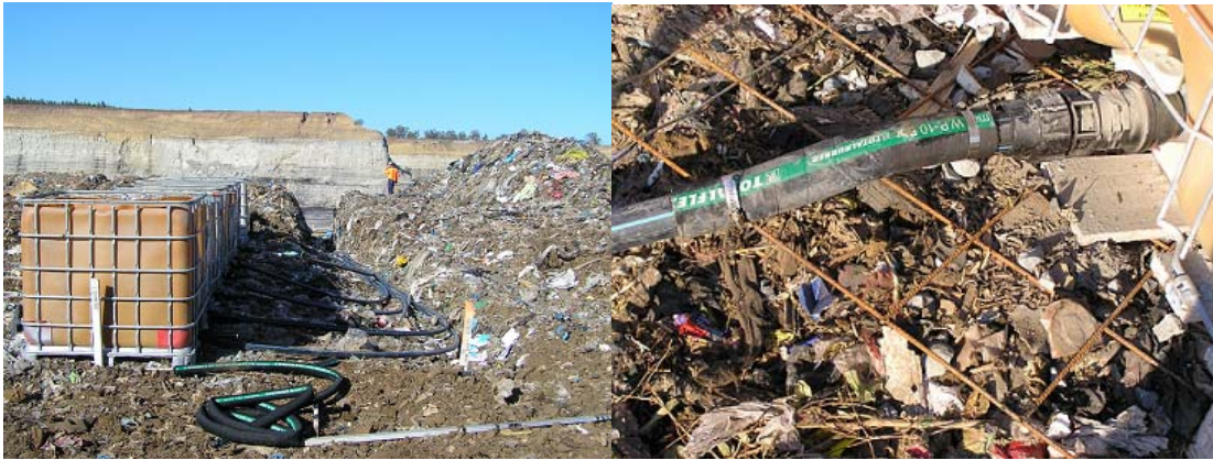
Figure 90 : Photos des lysimètres mis en place lors de l'étude préliminaire
