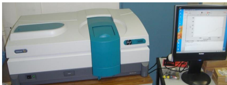
Figure 2.21 : Spectrophotomètre VARIAN Cary 5000 utilisé à l'INSA, département génie physique de Toulouse
