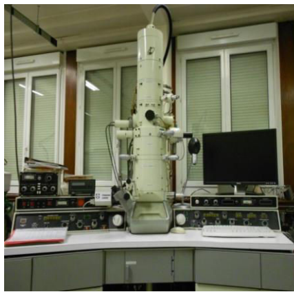
Figure 2.11 : Microscope électronique à transmission JEM-100CX utilisé à l'INSA, département génie physique de Toulouse
