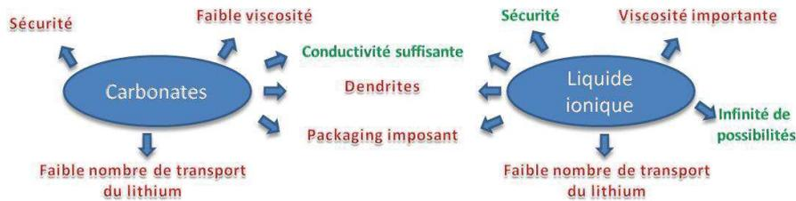
Figure 6: En vert les avantages et en rouge les inconvénients des électrolytes liquides
