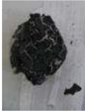
Figure 115: Dépôt du mélange cathodique sur la membrane PEO - OSS
