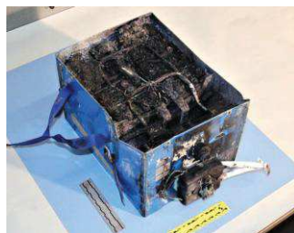
Figure 20: Photographie d'une batterie lithium-ion polymère ayant subi un incendie
