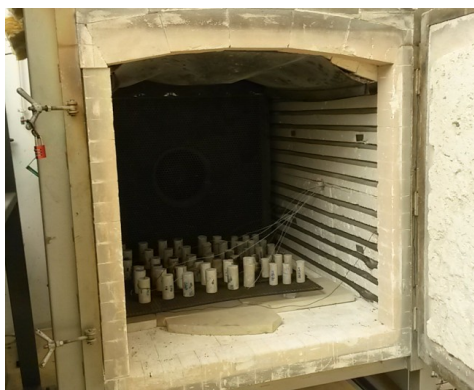
Figure II-24 Four électrique CMT et instrumentation.
