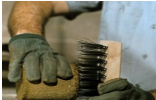
Figure I-52 Brossage selon la norme ASTM D559 ( Tayabji, 2016 ).
