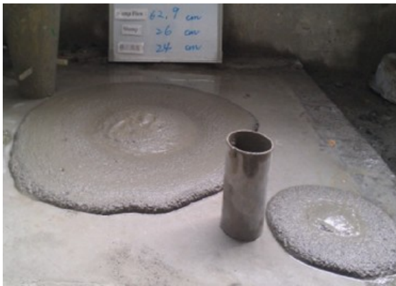
Figure I-13 Mesures d'étalement : cône et tube (Sheen et al. 2013).
