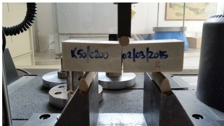
Figure II-16 Essais de résistance en flexion 3 points.
