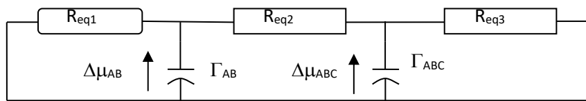
Figure A.9 : Schéma équivalent transitoire
