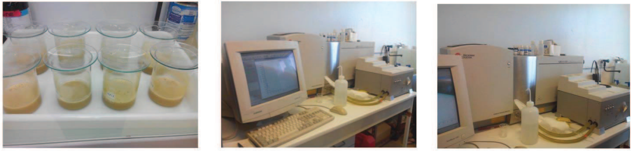
Figure 29 Détermination de la granulométrie moyennant un Beckman Coulter LS 13 320 granulomètre
