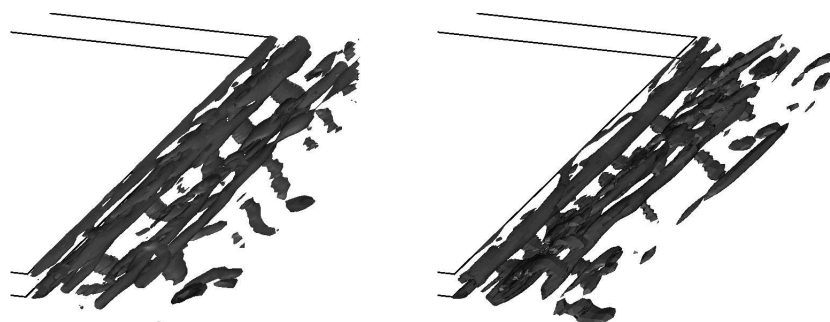
FIG. 8.49 – Visualisation 3D de l'écoulement (maillage grossier) : iso-valeurs du critère Q ; gauche : condition d'entrée turbulente ; droite : condition d'entrée laminaire .
