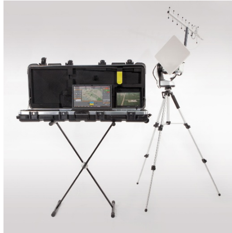
FIGURE 1.3 : Illustration d'une station sol déployée sur le terrain
