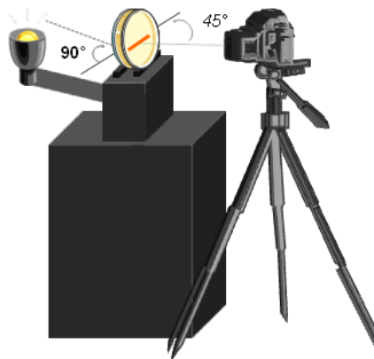
Figure 25. Montage pour l'observation de l'iridescence de colonies bactériennes en transillumination.
