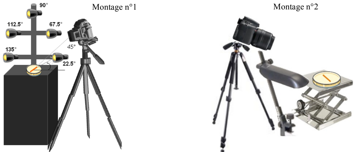
Figure 24. Montages pour l'observation de l'iridescence de colonies bactériennes en épi-illumination. Le montage n°1 est amélioré par la suite (montage n°2).
