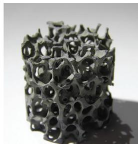
Figure 4: Photographie du catalyseur structuré composé d'un support en SiSiC sur lequel a été déposé le catalyseur NiRh/MgAl<sub>2</sub>O<sub>4</sub>.
