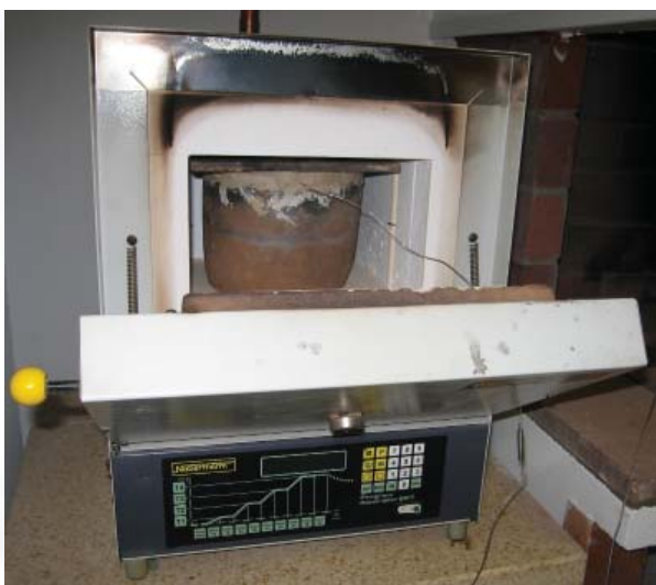
Fig. 57. Introduction du procédé simple pot en four à moufle.
