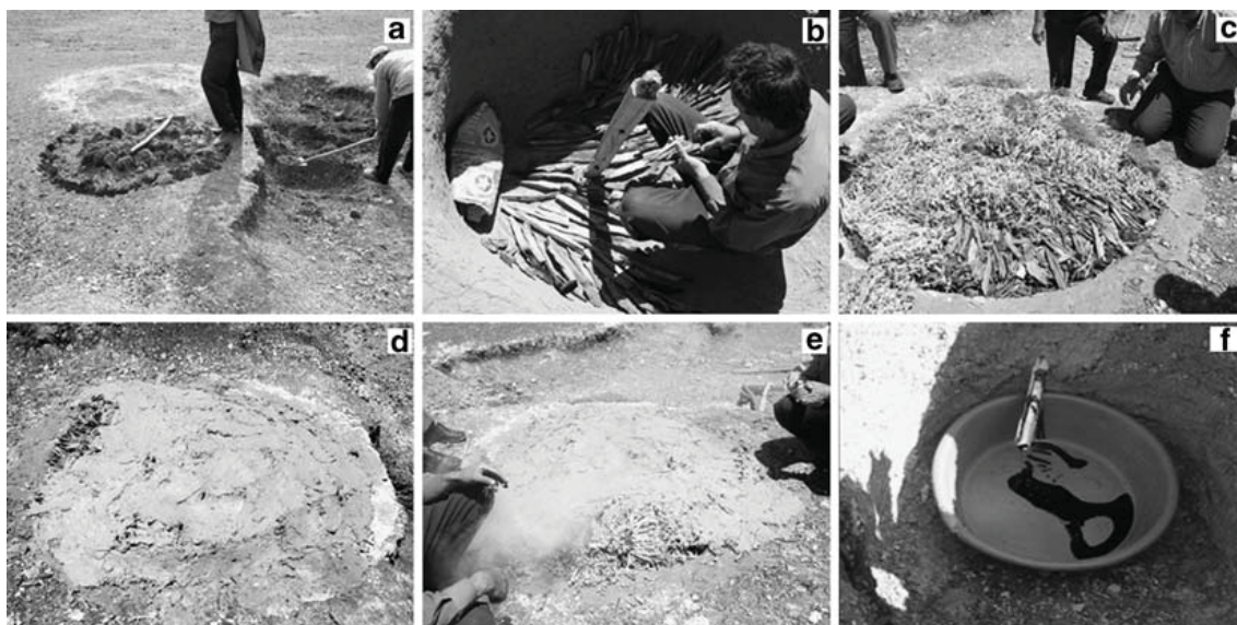
Fig. 28. Préparation d'un procédé sous charbonnière dans les montages de Taurus, Turquie d'après Kurt et al. , 2008. Étape a : les deux fosses sont creusées dans le sol ; Étape b : Mise en place du bois résineux dans le compartiment d'allumage ; Étape c : le compartiment d'allumage est recouvert d'une couche de feuille ou d'herbe fraîche ; Étape d : le compartiment d'allumage est recouvert d'une couche d'argile ; Étape e : allumage du procédé ; Étape f : récupération du goudron dans la seconde fosse, plus basse.
