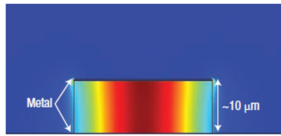
FIGURE I.16 – Simulation en 2D du champ THz confiné dans une cavité à guide double-métal. Figure issue de [19].
