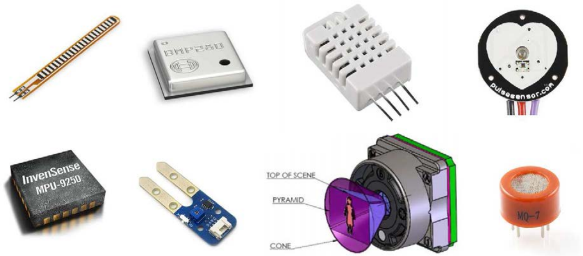
FIGURE A.5 – Exemples de capteurs utilisés dans les nœuds de capteurs sans fil. (De gauche à droite) capteur de flexion [140], capteur de pression [52], capteur d'humidité [118], capteur de pulsation [19], centrale inertielle [90], capteur d'humidité du sol [14], imageur [142], capteur de monoxyde de carbone (CO) [171]
