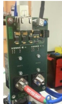
Figure 4.15 Photographie de la connectique optique, et de la carte électronique supportant les photomultiplicateurs (Hamamatsu) et une partie de l'électronique de contrôle
