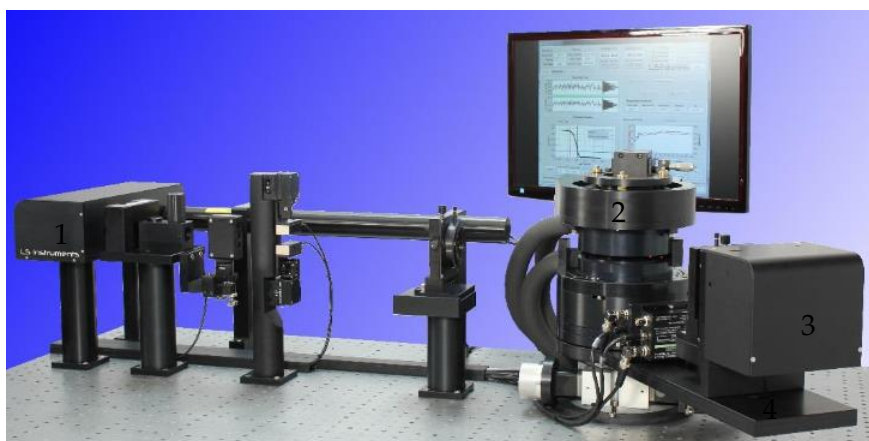
Figure 2.21 Photographie du dispositif 3D LS Spectrometer [4]
