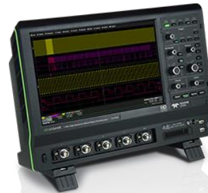
Figure 4.21 Photographie de l'oscilloscope Lecroy HD06034
