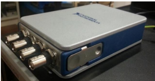
Figure 4.20 Photographie de la carte d'acquisition NI 9215 dans son châssis NI cDAQ-9171
