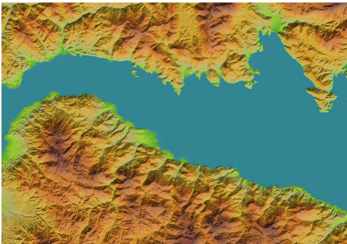
Fig. 3.7: Extrait du Modèle Numérique de Terrain du Golfe de Corinthe (d'après Pantosti). Ce MNT a été produit par la société ISTAR à partir d'un couple stéréoscopique SPOT.
