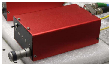
FIGURE 3.12 – Module incluant la ligne à retard fibrée et le modulateur de chemin optique. Cet élément comporte 4 \text{ m} de fibre unimodale à 810 \text{ nm} et à maintien de polarisation.
