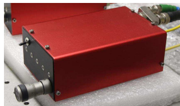
FIGURE 3.12 – Module incluant la ligne à retard fibrée et le modulateur de chemin optique. Cet élément comporte 4\ \text{m} de fibre unimodale à 810\ \text{nm} et à maintien de polarisation.
