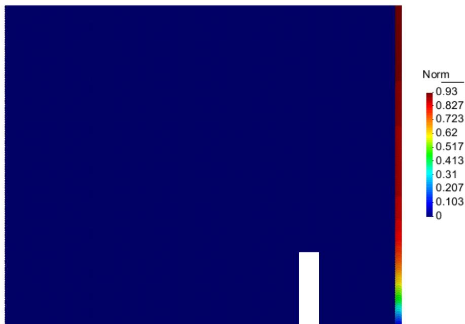
Figure 4.22: Profil de vitesse d'entrée normalisée
