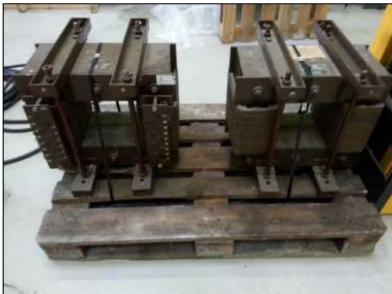
Figure 31 : Alimentation des modèles réduits de câbles – Transformateurs de courant
