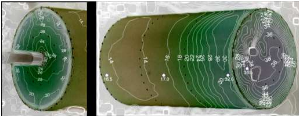
Figure 9 : Températures mesurées par le dépôt de cristaux thermo-sensibles TLC [18]
