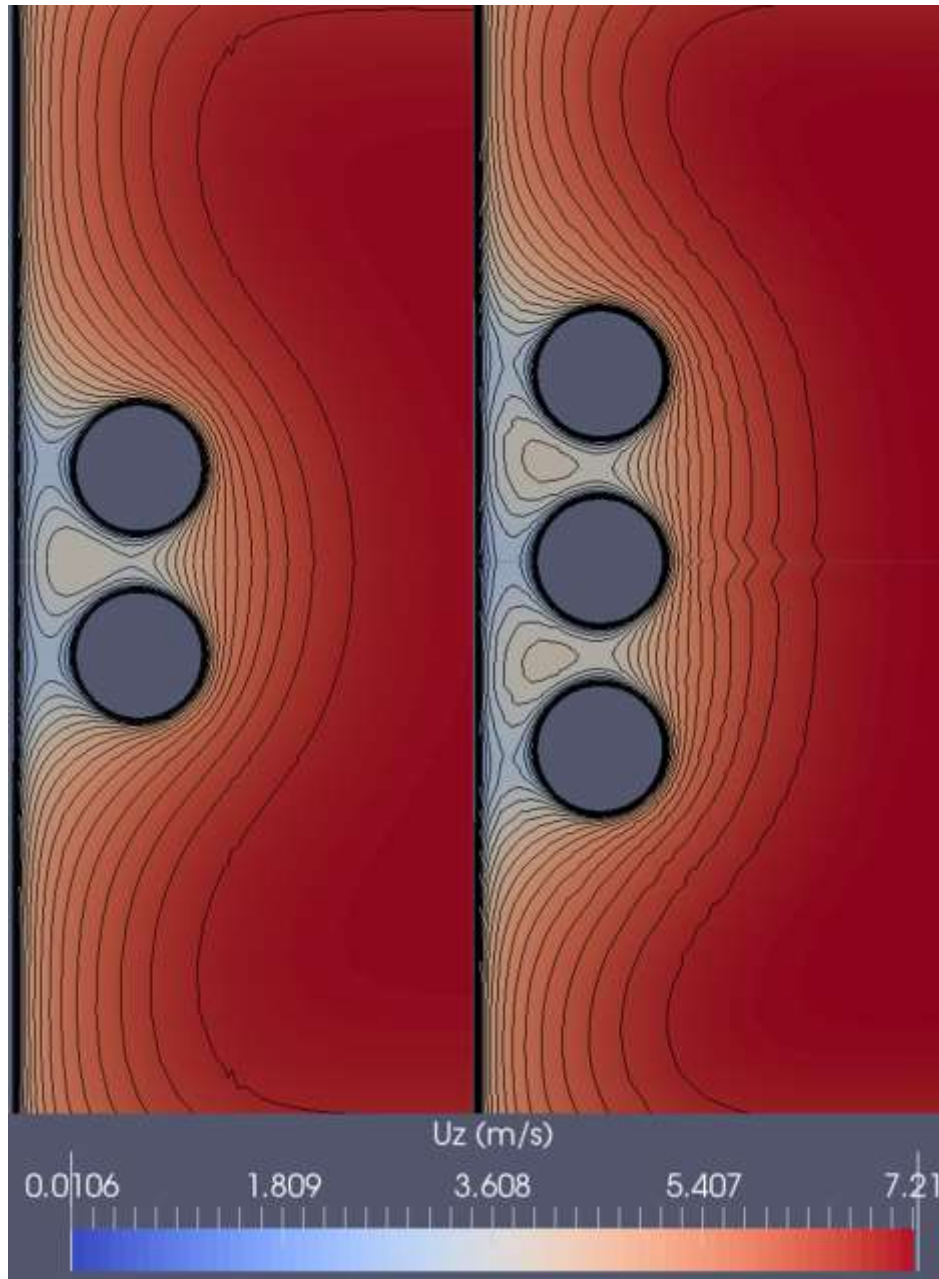
Figure 91 : Champs de vitesse pour les cas 2 et 3 câbles en nappe verticale – Re_{De} = 11660
