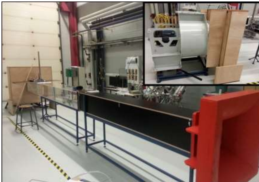
Figure 28 : Veine d'écoulement et moyen de ventilation
