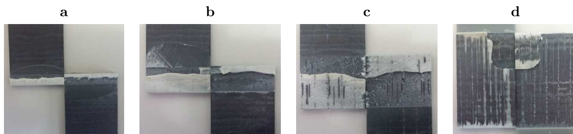
FIGURE 6.12 – Faciès de rupture pour des substrats ayant pour empilement [0_2, 90_2]_s avec une épaisseur de joint de colle de 0.4 mm et une longueur de recouvrement égale à (a) 5 mm, (b) 10 mm, (c) 20 mm et (d) 40 mm.
