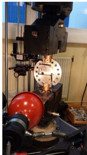
FIGURE 2.17 – Dispositif Arcan mis en place sur la machine de traction.
