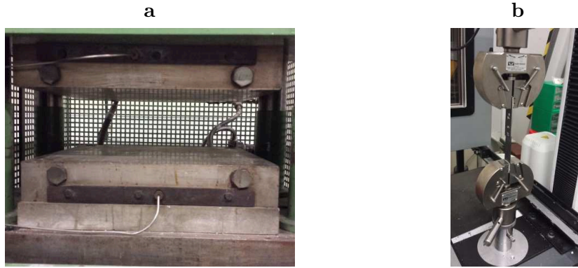
FIGURE 6.10 – Moyens expérimentaux utilisés pendant la campagne expérimentale sur les assemblages collés de simple recouvrement : (a) presse chauffante utilisée pour polymériser la colle et (b) machine de traction universelle utilisée.
