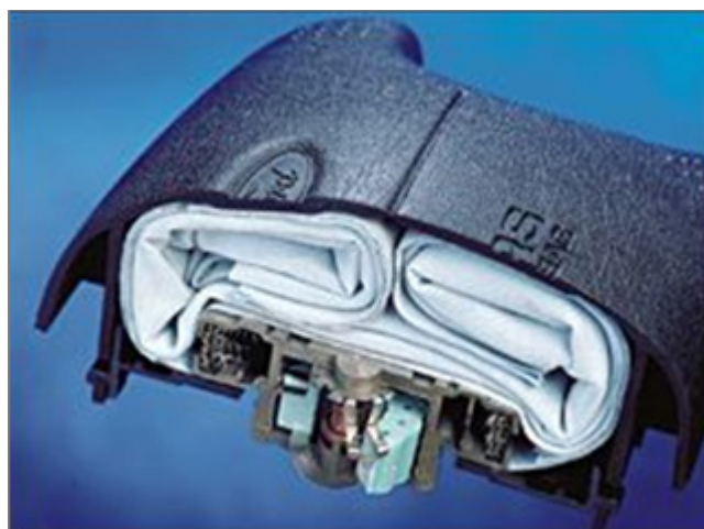
FIGURE I-21 : PLIAGE DU SAC D'UN AIRBAG CONDUCTEUR - FORD
