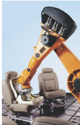
Figure 1.2. - Robot KUKA avec redistribution des masses.
