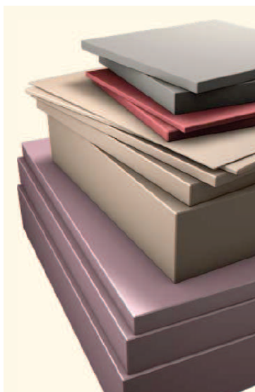
FIGURE 6.4 : Photographie des plaques d'inserts CIRS de densités et d'épaisseurs variables mimant les tissus osseux et pulmonaires.
