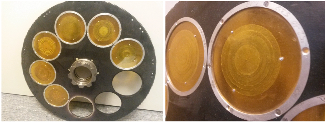
FIGURE 1.14 : Photographies d'un carrousel issu de la tête d'un accélérateur Saturne 43 portant différents filtres diffuseurs interposés dans le faisceau d'électrons primaires. Ces filtres sont donc spécifiques d'une énergie nominale ou d'un groupe d'énergies proches.
