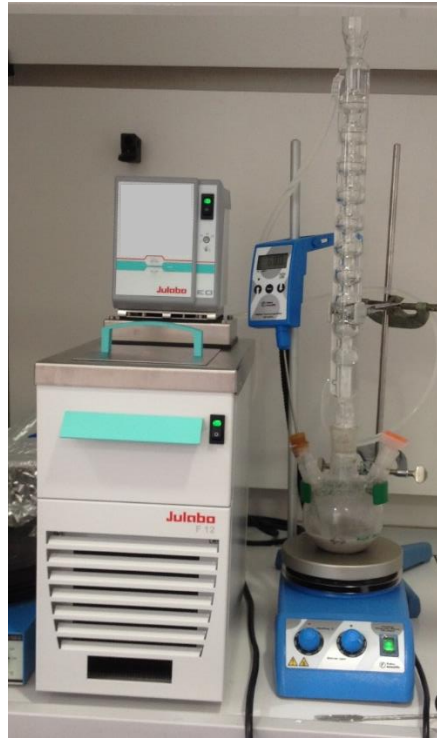
Figure 4-20. Dispositif expérimental pour la dissolution du nickel en solution ammoniacale
