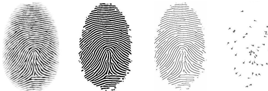
FIGURE 4.3 – Étapes de traitement et d'extraction de minuties de l'empreinte digitale à partir de [101]. Empreinte en niveaux de gris, empreinte après binarisation, squelette et minuties extraites.
