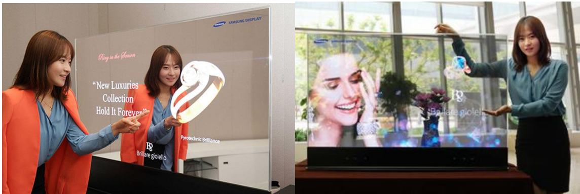
Fig. 2. Prototypes d'écran à effet miroir (à gauche) ou transparent (à droite) de l'entreprise Samsung [6].
