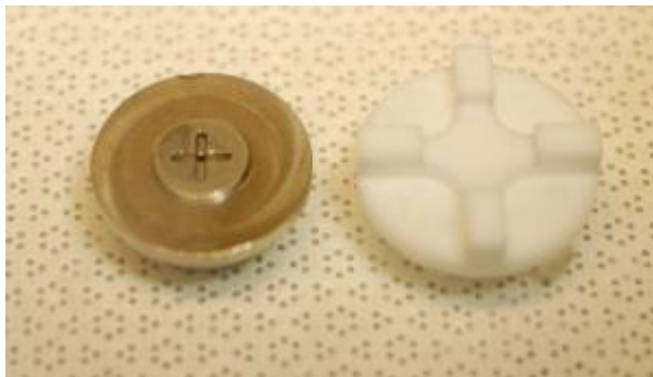
Fig. II-7. Porte-substrat en téflon développé par Florence Archet (à droite).
