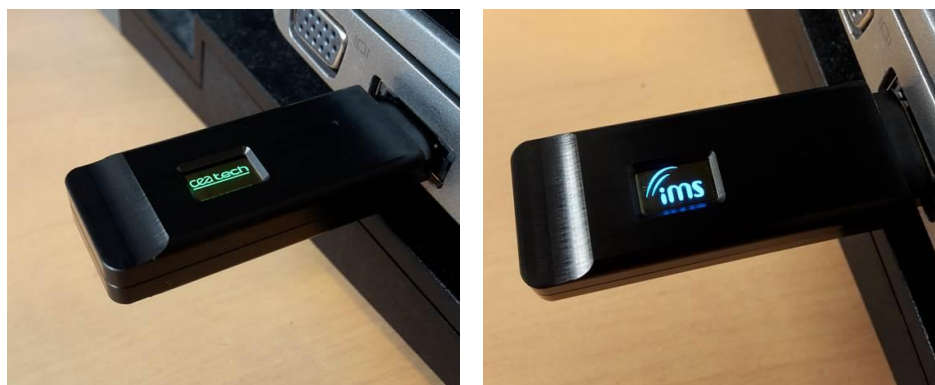
Fig. V- 12. Clés USB contenant une OLED bleue à architecture directe (à gauche) et verte à architecture inverse (à droite).
