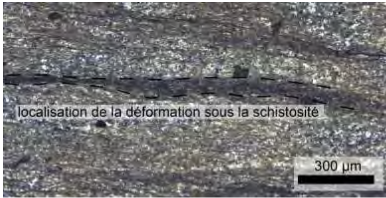
Figure II-23 : Talcite schistosée sub-parallèle à une foliation vue au microscope optique en LPA (x100).
