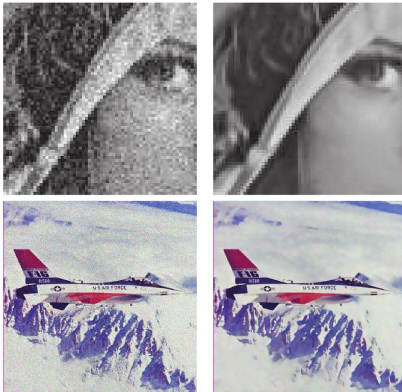
FIGURE 4.3 – Exemples d'application au débruitage d'image de la méthode basée patch avec la version bruitée de l'image (colonne de gauche) et sa version débruitée (colonne de droite). Extrait de [BUADES 2005].
