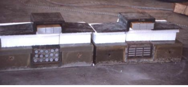
Fig. 2: Section transversale de l'émetteur enterré et du récepteur embarqué du prototype PATH.
