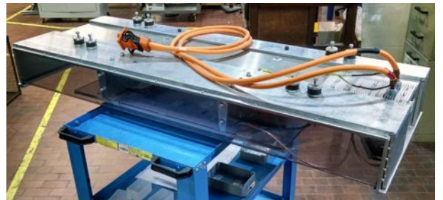
Fig. 13: Structure de réception complète prête à être montée sous le véhicule.
