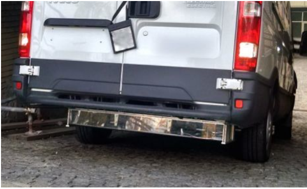
Fig. 14: Récepteur monté sous le véhicule.
