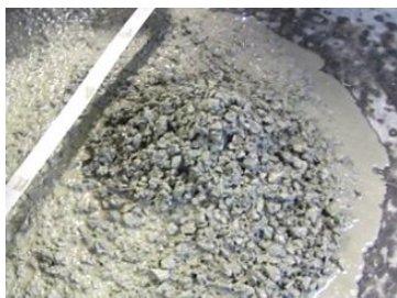
Figure 3-12 : Apparition d'un dôme de granulats au centre de la galette
