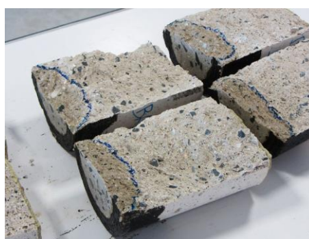
Figure 3-15 : Profil de pénétration d'eau
