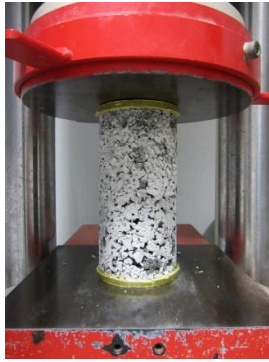
Figure 3-16 : Essai de compression sur cylindre
