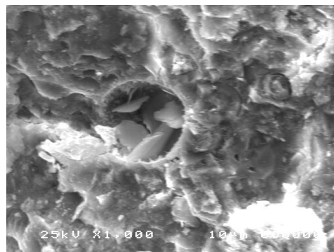
Figure 4-30 : Présence de portlandite à l'intérieur des bulles d'air du BP-40
