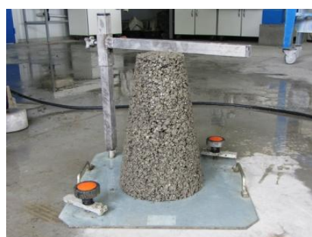
Figure 3-9 : Essai d'affaissement du béton poreux
