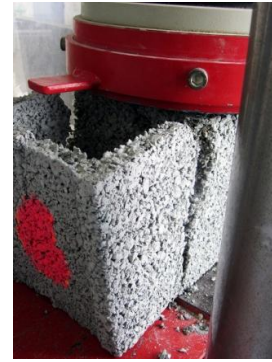
Figure 3-18 : Essai de compression sur bloc
