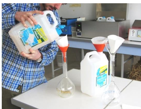
Figure 2-16 : Filtration des éluates
