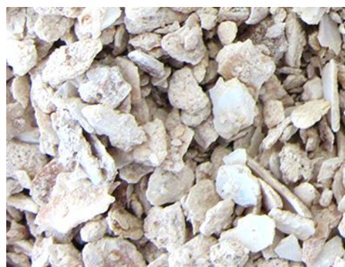
Figure 2-11 : Forme aplatie des coquilles concassées ( d > 4 mm)
