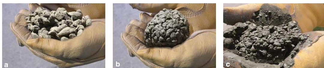
Figure 1-3 : Influence du dosage en eau sur la cohésion du béton poreux : a. insuffisant ; b. approprié ; c. trop élevé (Tennis et al., 2004)
