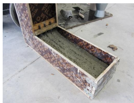
Figure 3-11 : Essai à la boîte en L (L-Box)
