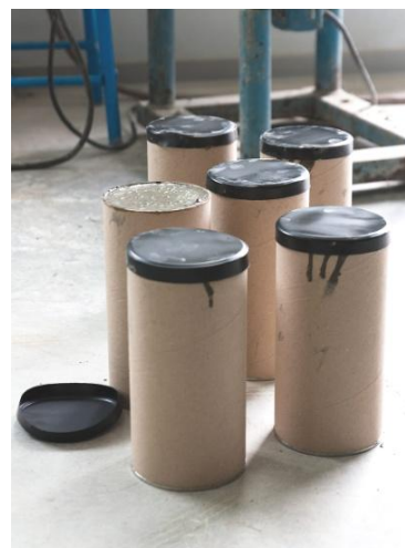
Figure 3-7 : Éprouvettes cylindriques Ø11x22 cm
