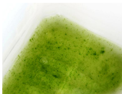
Figure 2-17 : Apparition de biomasse dans les éluates
