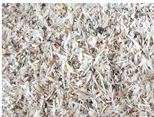
Figure 2-10 : Forme aciculaire des coquilles concassées ( d < 2 mm)
