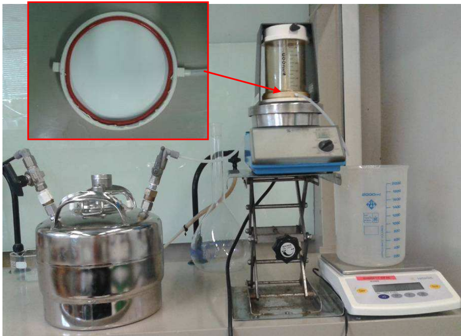
Figure II-22 : Photo du montage de l'installation d'ultrafiltration
