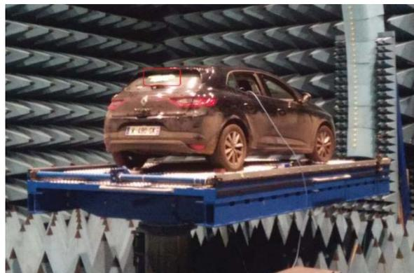
Figure 7 : La configuration de mesure d'une antenne patch sur la lunette arrière.
