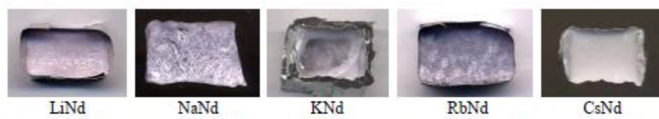
Figure 6 : Observations macroscopiques des verres \text{SiO}_2 - \text{B}_2\text{O}_3 - \text{Al}_2\text{O}_3 - \text{M}_2\text{O} - \text{CaO} - \text{ZrO}_2 - \text{TR}_2\text{O}_3 après un refroidissement de 1°C/min dont la nature de l'alcalin est variable ( M : \text{Li}^+, \text{Na}^+, \text{K}^+, \text{Rb}^+ et \text{Cs}^+ ) 1 .
