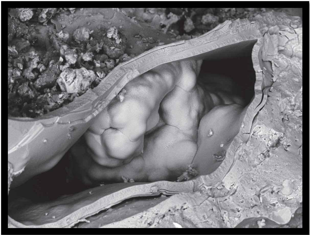
Image MEB de la phase amorphe porteuse de métaux
