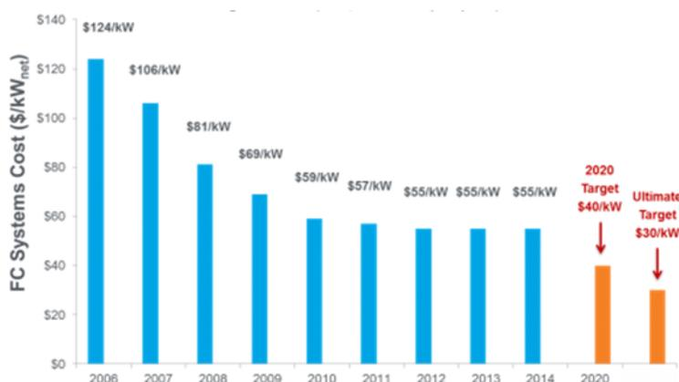
Figure 19 : Evolution de l'estimation (10% d'erreur) du coût de production d'un système PEMFC à échelle industrielle depuis 2006 (500 000 unités/an) [95].
