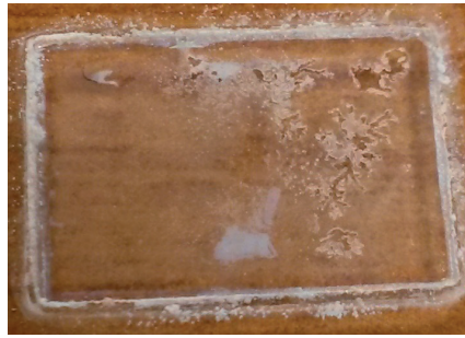
FIGURE 1.42 – Photo d'une opale inverse après plus de 5 jours dans une solution de HF à 4%.
