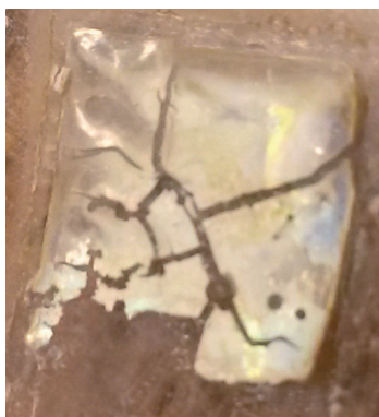
FIGURE 1.46 – Photo d’une opale inverse avec un rapport molaire EGDMA/MAA=1/9, réalisée à partir d’une opale de billes de silice de 343 nm de diamètre synthétisée initialement sur un substrat de PMMA et d’un mélange de 400 \mu\text{L} de MAA (99%), 100 \mu\text{L} d’EGDMA (98%), 40 mg de bisphénol A (97%) et 4 mg d’AIBN (98%) dans 400 \mu\text{L} d’éthanol absolu.
