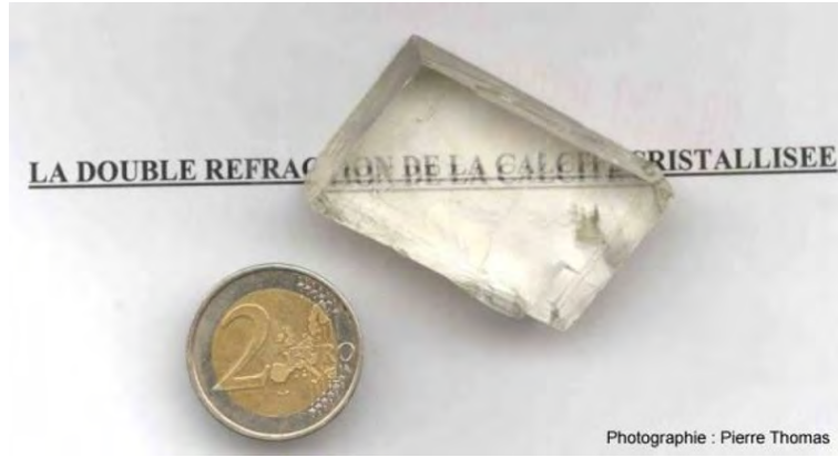
FIGURE 1.2 – Illustration de la double réfraction d'un bloc de calcite biréfringent.
