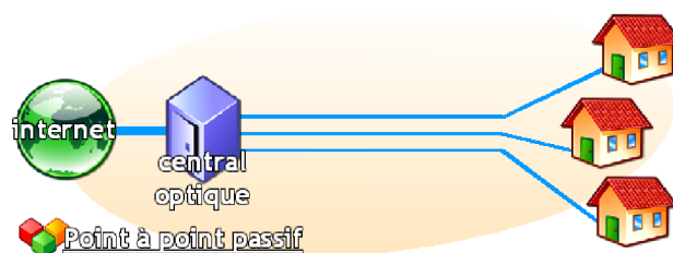
Figure 1.3 – Réseau d'accès point à point [1]
