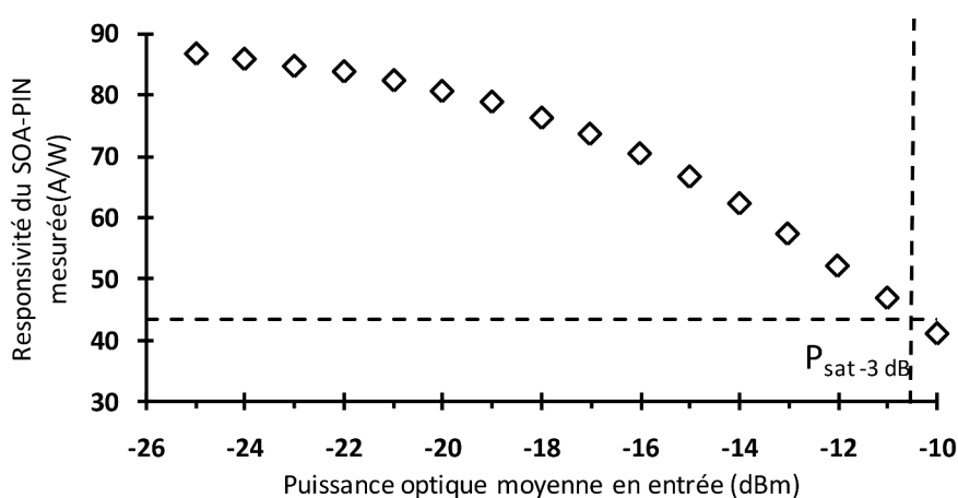
Figure 4.35 – Sensibilité mesurée du SOA-PIN
