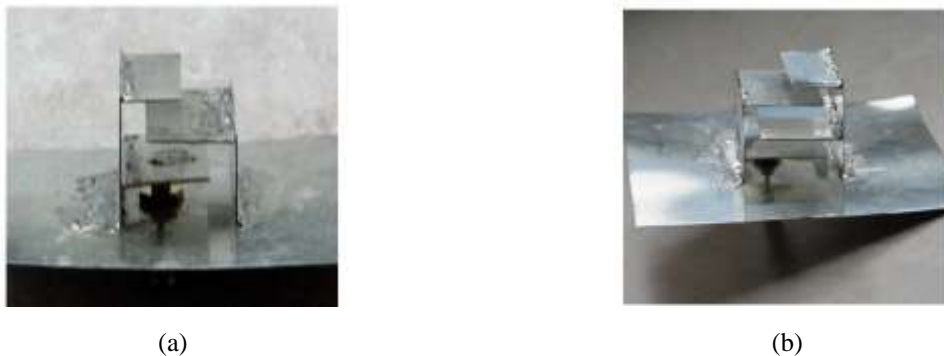
Figure I. 15: Prototype de l'antenne repliée pour adresser: la bande 1575 MHz (a) la bande 896 MHz (b) [26].
