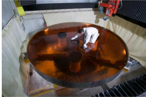
*Figure 1 : Fabrication d'un miroir Zerodur® pour un télescope par SCHOTT*
