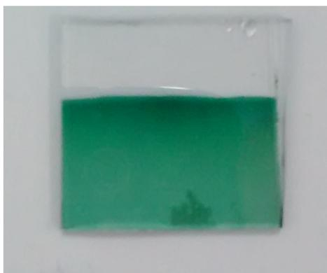
FIGURE 142. – Couche de Polyaniline électrodéposée (Potentiel de +1V pendant 3 min) sur un substrat verre-ITO
