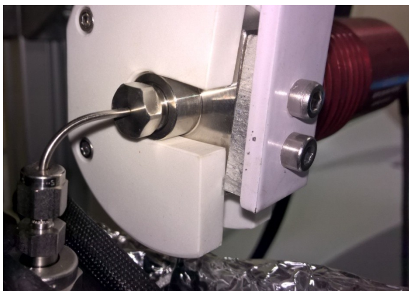
Figure 66: Capillaire de prélèvement d'échantillon entre le tube de la pompe à chaleur et la vanne d'échantillonnage.
