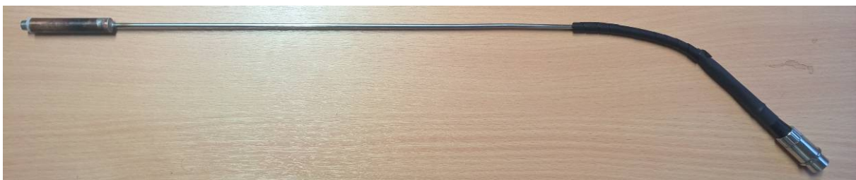
Figure 35: Sonde étalon de température assemblée.
