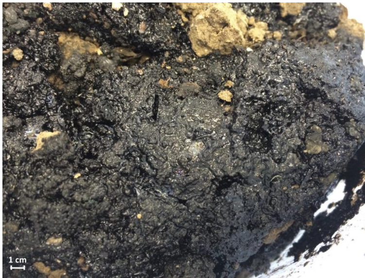
Figure 20 : Goudron de houille de l'ancienne usine à gaz de Pontoise
