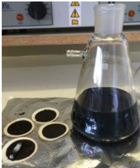
Figure 74 : Solution-mère de goudron de houille après extraction manuelle au chloroforme et filtration à chaud
