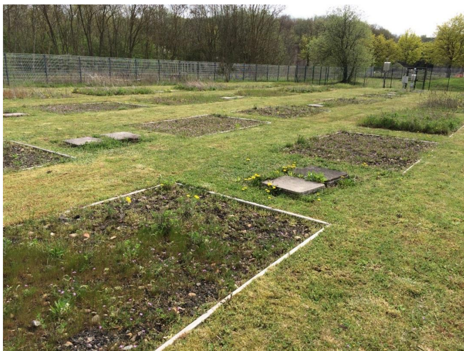
Figure 50 : Parcelles lysimétriques de la station expérimentale du GISFI (Homécourt, Grand Est, France)
