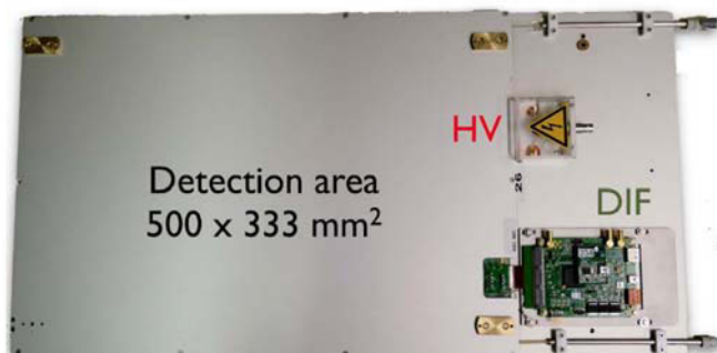
Figure 3.5 – Photographie d’une chambre GRPC utilisée pour le détecteur TOMUVOL. La carte DIF assurant l’interface entre les ASIC et la système d’acquisition de données est visible, ainsi que le connecteur haute tension et les entrée/sortie de gaz.
