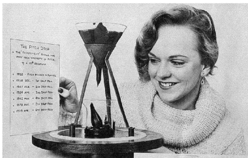
**Figure 1 :** « The pitch drop experiment » (d'après [2]).
