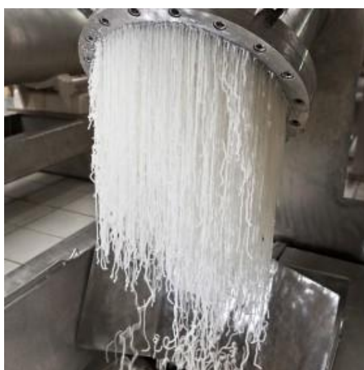
Figure 2 : Extrusion de bouillon concentré et gélifié de gélatine (d'après [5]).
