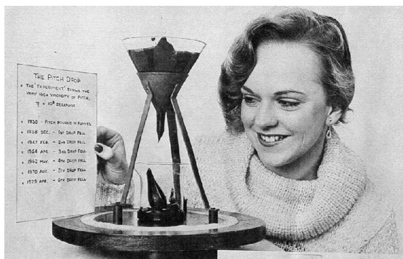
Figure 1 : « The pitch drop experiment » (d'après [2]).
