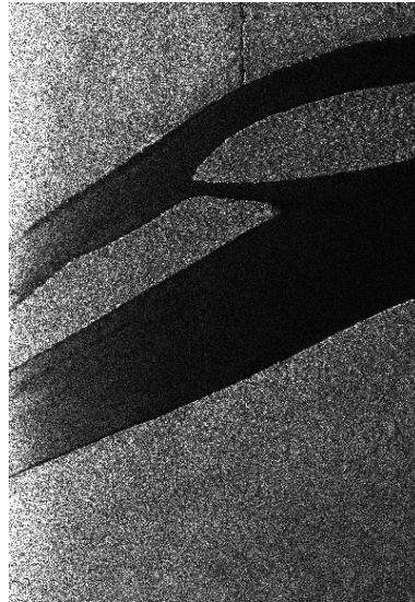
FIGURE 3.2 – Image SAR d’amplitude obtenue par le système ONERA Sethi dans le cadre du projet TropiSAR présentant une radiométrie variable entre le début de la fauchée (à gauche) et la fin (à droite) en raison du lobe d’antenne.
