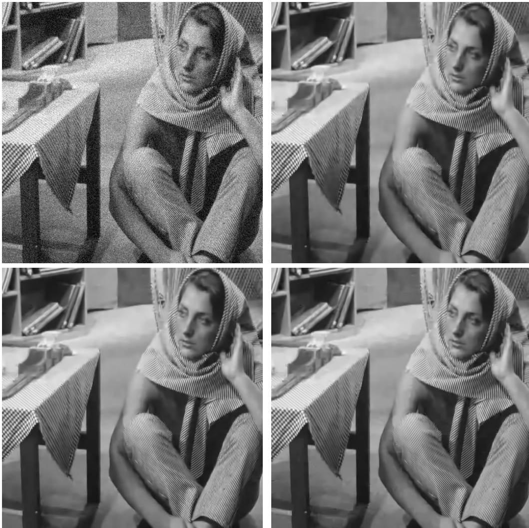
FIGURE 5.2 – De gauche à droite et de haut en bas : image bruitée ( \sigma = 20 ), images débruitées avec l'EPLL classique, l'aEPLL et l'iEPLL. La taille des GMM utilisée est de 200 modèles.
